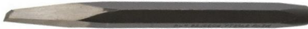
รูปที่ 40 สกัดปากเฉียงหรือปากเหลี่ยม ( Diamond point chisel )
