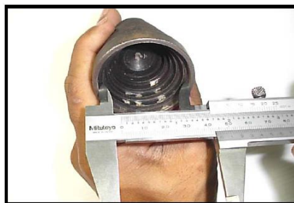
รูปที่ 3.5 แสดงวิธีการใช้เวอร์เนียคาลิปเปอร์วัดขนาดภายใน
