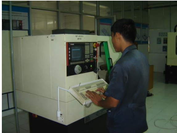
รูปที่ 1-12 แสดงการป้อนโปรแกรมโดยการพิมพ์ ที่มา : แผนกวิชาเครื่องมือกล วิทยาลัยเทคนิคนครนายก
