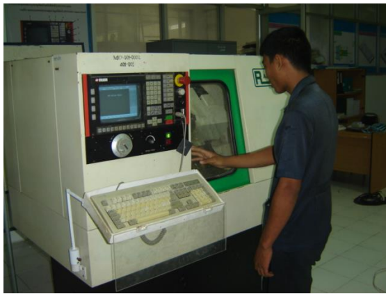
รูปที่ 1-10 แสดงการใช้เครื่องกลึงซีเอ็นซีผลิตชิ้นงาน โดยใช้โปรแกรมซีเอ็นซีควบคุม ที่มา : แผนกวิชาเครื่องมือกล วิทยาลัยเทคนิคนครนายก
