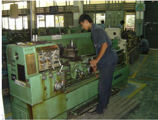
รูปที่ 1-9 แสดงการใช้เครื่องกลึงธรรมดาผลิตชิ้นงาน โดยผู้ใช้ต้องปฏิบัติงานทุกขั้นตอน ที่มา : แผนกวิชาเครื่องมือกล วิทยาลัยเทคนิคนครนายก
