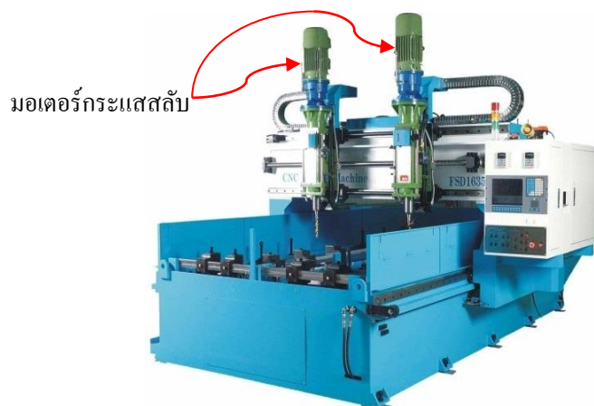
รูปที่ 1-19 แสดงการนำมอเตอร์กระแสสลับมาใช้กับเครื่องเจาะซีเอ็นซี ที่มา : เอกสารแนะนำสินค้าบริษัทวีต้าแมชชีนเนอร์รี่จำกัด
