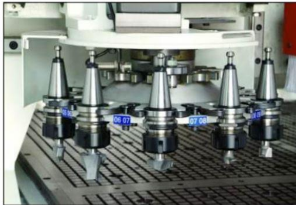
รูปที่ 4.18 แสดงชุดอุปกรณ์จัดเก็บเครื่องมือตัดชนิดจานหมุนเปลี่ยนอัตโนมัติ (Carousel Type Tools Magazine)
