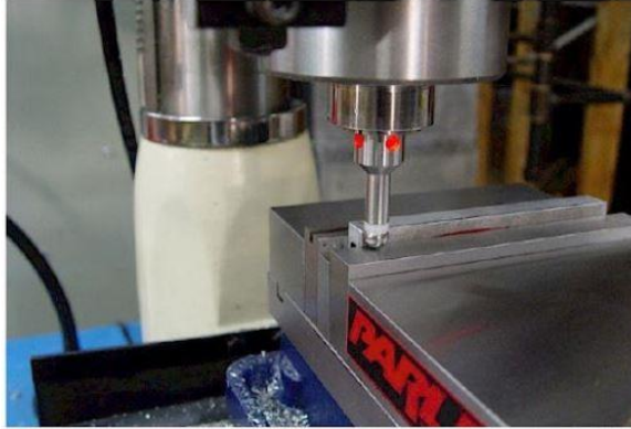
รูปที่ 4.17 แสดงการใช้งานอุปกรณ์หาขอบผิวชิ้นงาน (Edge Finder)
