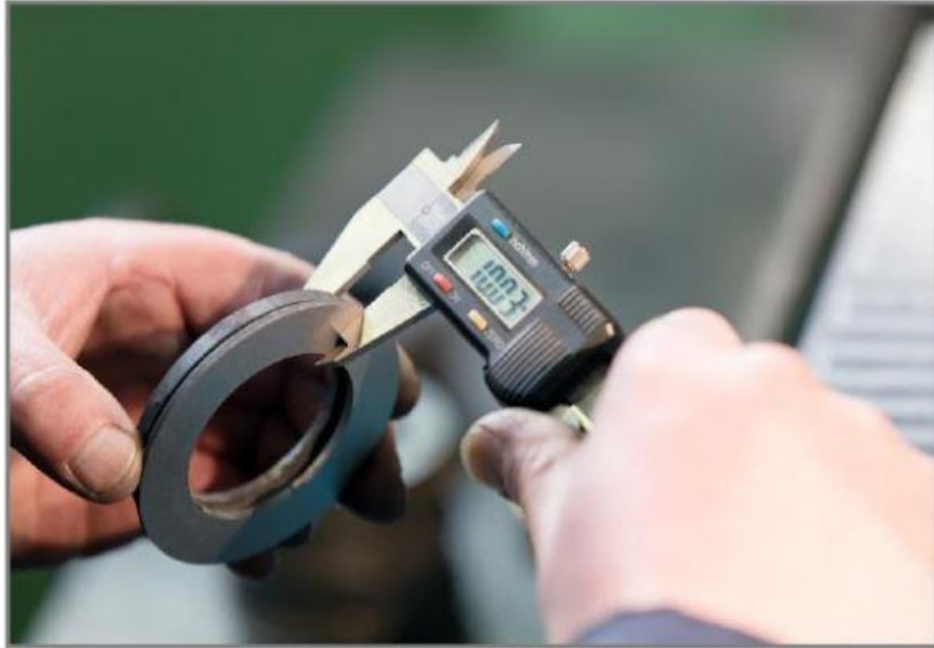
รูปที่ 5.19 แสดงการใช้เวอร์เนียคาลิเปอร์เพื่อตรวจสอบขนาดชิ้นงานกลึง
