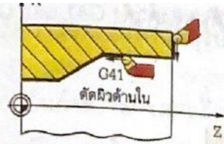
(ก) การใช้คำสั่ง G41 สำหรับงานปาดผิวหน้าและตัดผิวด้านใน
