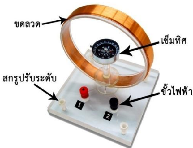
รูปที่1 ลักษณะของแทนเจนต์กัลวานอมิเตอร์
