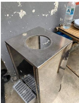
ภาพที่ 3.5 นำแผ่นอะลูมิเนียมมาพับปิดส่วนที่เป็นช่องว่าง ของโครงตู้กักน้ำให้เรียบร้อย
