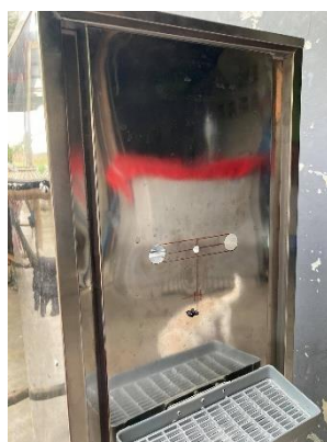
ภาพที่ 3.2 กำหนดตำแหน่งก๊อกน้ำและเซ็นเซอร์
