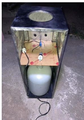
ภาพที่ 3.3 ติดตั้งฐานรองรับก๊อกน้ำและเซ็นเซอร์
