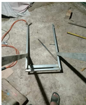
ภาพที่ 3.1 นำเหล็กมาเชื่อมทำเป็นโครง
