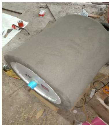
ภาพที่ 3.3 นำถังน้ำมาติดกับฟองน้ำนำเหล็กมาเชื่อมทำเป็นโครง
