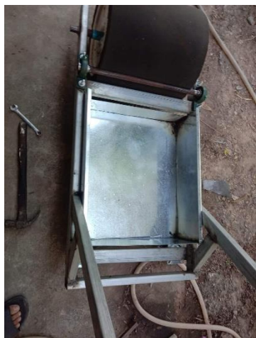
ภาพที่ 3.4 เอาถาดมาเชื่อมแล้วนำมาประกอบ
