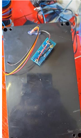
รูปภาพภาคผนวก ก ที่ 5 ทำการต่ออะแดปเตอร์แปลงไฟ เข้ากับโมดูลรีเลย์
