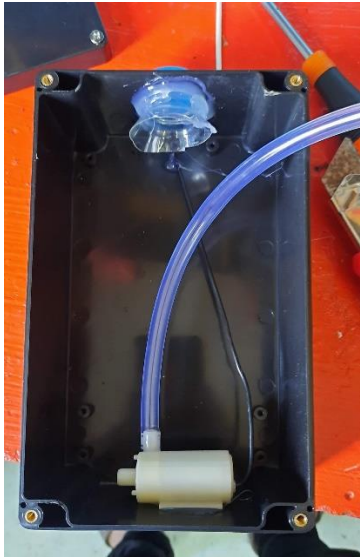
รูปภาพภาคผนวก ก ที่ 7 ต่อสายยางส่งเจลเข้ากับเครื่องปั๊มดูด ขนาดเล็ก
