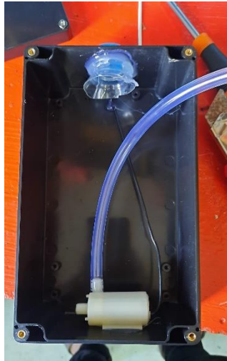
ภาพที่ 3.8 ต่อสายยางส่งเจลเข้ากับเครื่องปั๊มดูขนาดเล็ก
