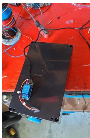
ภาพที่ 3.7 ทำการติตรีเลย์กับเซ็นเซอร์ไว้ใต้กล่อง
