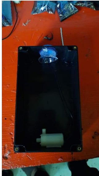
รูปภาพภาคผนวก ก ที่ 2 ทำการติดตั้งเครื่องปั๊มดูดเจลในกล่อง
