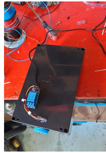
รูปภาพภาคผนวก ก ที่ 6 ทำการติตรีเลย์กับเซ็นเซอร์ ไว้ใต้กล่อง
