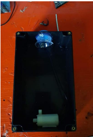
รูปภาพภาคผนวก ก ที่ 4 ทำการต่อมอเตอร์ดูดเจล กับเซ็นเซอร์
