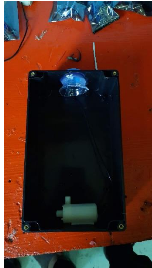
ภาพที่ 3.3 ทำการติดตั้งเครื่องปั๊มดูดเจลในกล่อง
