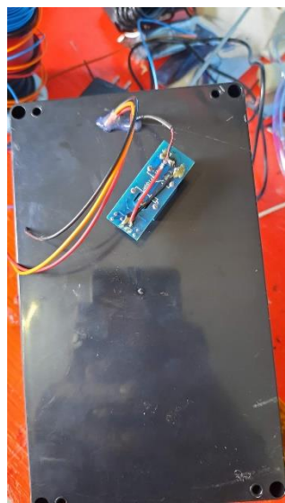
ภาพที่ 3.6 ทำการต่ออะแดปเตอร์แปลงไฟเข้ากับโมดูลรีเลย์
