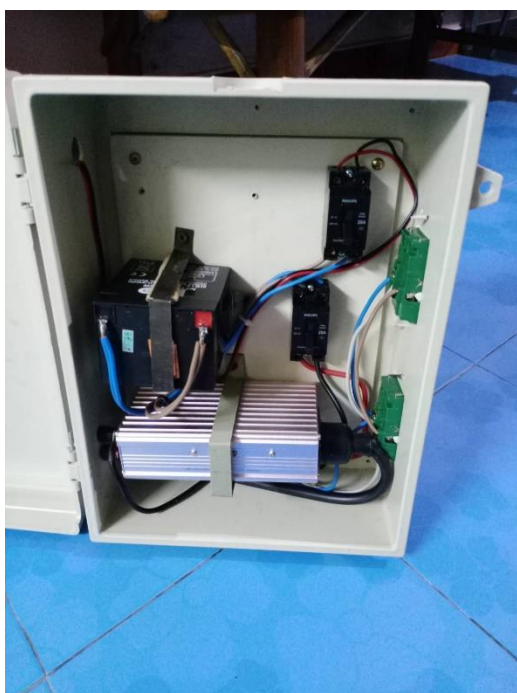
ภาพที่ 8 แสดงลักษณะ โครงสร้างของ ตัว ตู้สำรองไฟ
