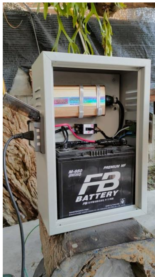
รูปที่ 21 แสดงลักษณะของการใช้อุปกรณ์แปลงไฟฟ้า
