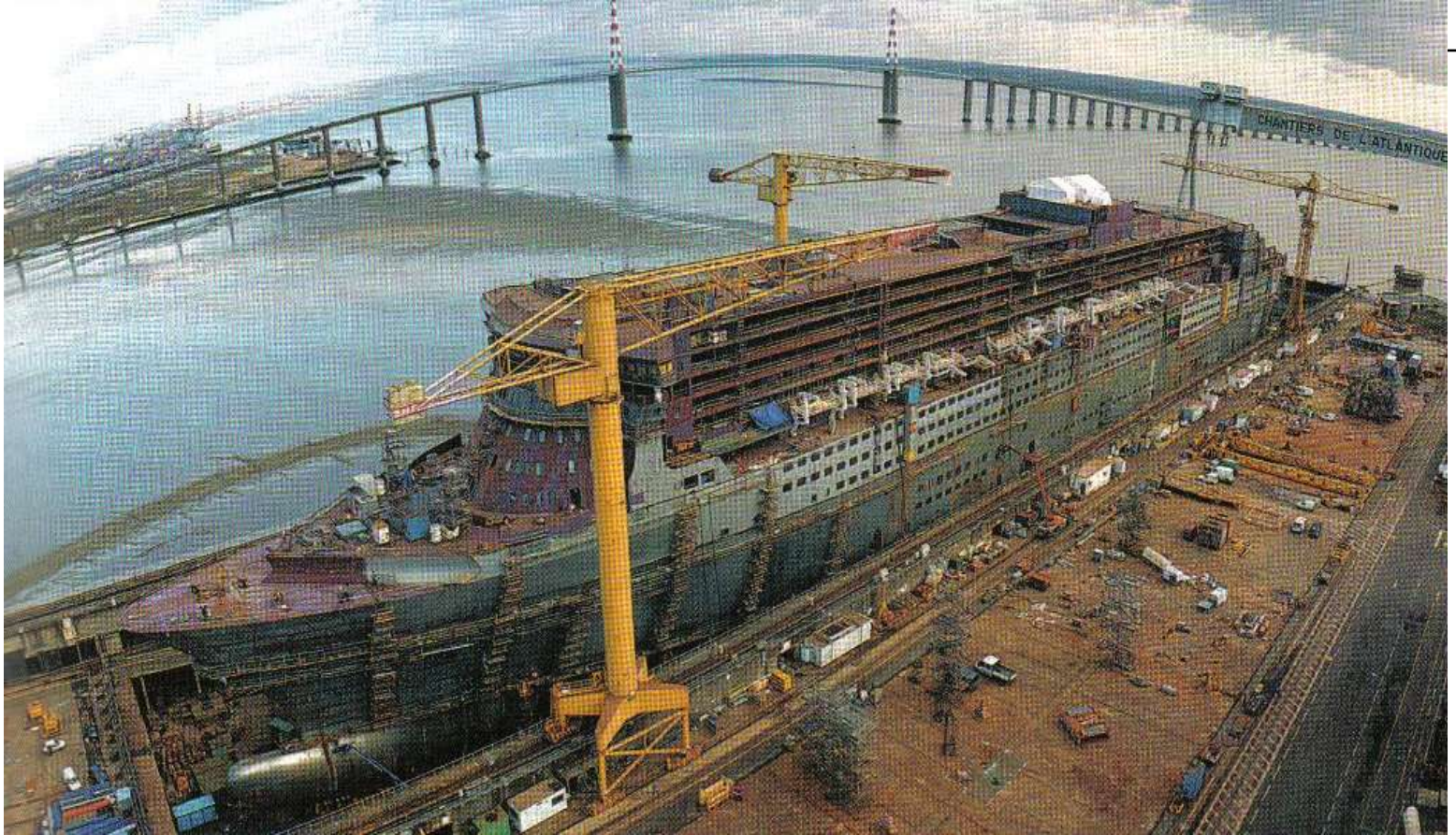
ภาพที่ 6.5 แสดงแผนผังกระบวนการผลิตตามแบบผลิตภัณ์ที่อยู่กับที่ ที่มา : Stevenson, 2005, p. 233
