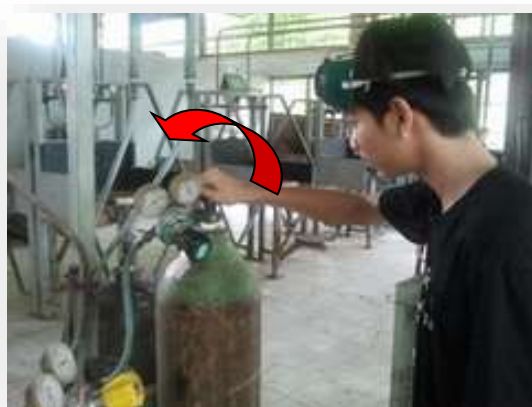
รูปที่ 2.69 แสดงการเปิดวาล์วที่ถังแก๊สออกซิเจน
