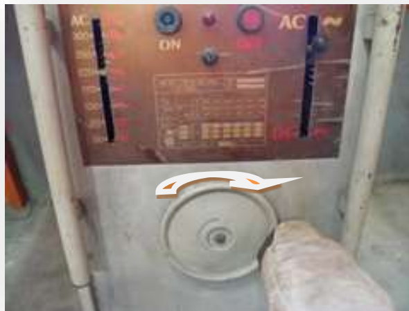
รูปที่ 1.133 แสดงลักษณะเปิดเครื่องเชื่อม ปรับกระแสไฟเชื่อม 70 – 90 แอมป์
