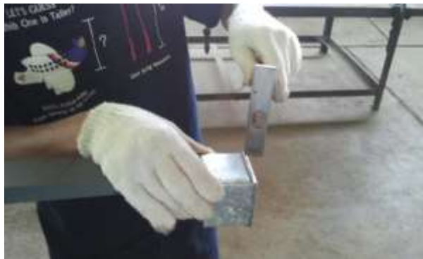
รูปที่ 3.171 แสดงการใช้ค้อนเคาะฐานกล่องสี่เหลี่ยมโดยตีพับตะเข็บสองชั้นทั้ง 4 ด้าน
