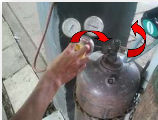
รูปที่ 2.160 ลักษณะการปรับความดันแก๊สอะเซทิลีน
