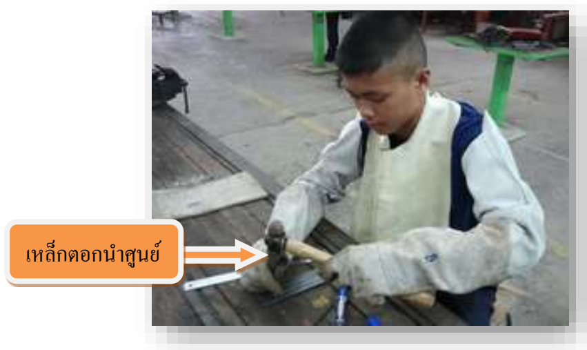
รูปที่ 1.80 แสดงเหล็กตอกนำศูนย์ตอกตามเส้นร่างแบบ
