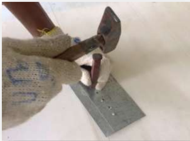
รูปที่ 3.157 แสดงการเคาะหัวหมุดให้สวยงาม
