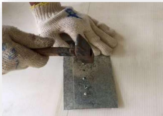
รูปที่ 3.156 แสดงขั้นตอนการเคาะหัวหมุด
