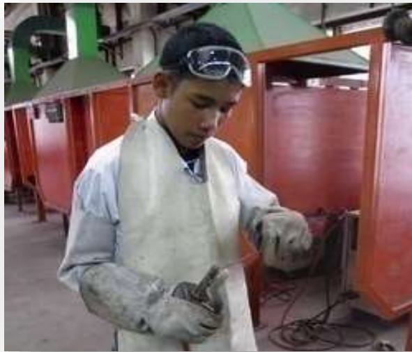
รูปที่ 1.30 แสดงการใส่ลวดเชื่อมกับหัวจับลวดเชื่อม
