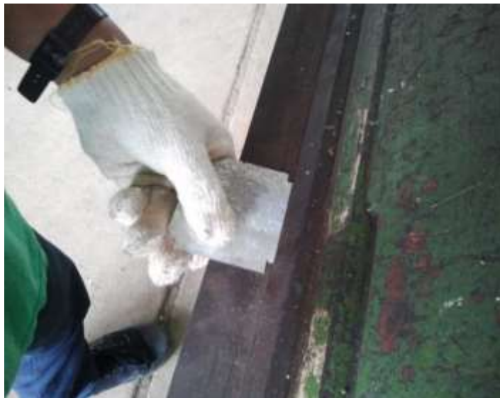
รูปที่ 3.168 แสดงการพับขึ้นรูปชิ้นงานส่วนกันกล่องสี่เหลี่ยม
