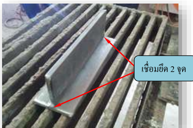
รูปที่ 1.134 แสดงลักษณะการยึดชิ้นงานให้เป็นรูปตัวที่
