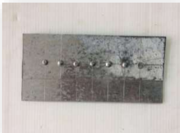
รูปที่ 3.157 แสดงการเคาะหัวหมุดให้สวยงาม
