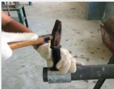
รูปที่ 3.128 แสดงการใช้เหล็กย้ำตะเข็บ
