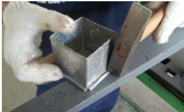
รูปที่ 3.170 แสดงการใช้ค้อนเคาะพื้นฐานกล่องสี่เหลี่ยมให้แน่นทั้ง 4 ด้าน
