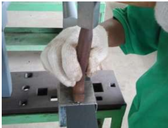
รูปที่ 3.166 แสดงการย้ำตะเข็บด้วยเหล็กย้ำตะเข็บ
