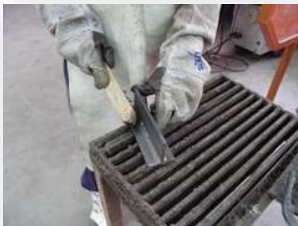
รูปที่ 1.138 แสดงการขัดด้วยแปรงลวดให้สะอาด
