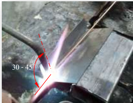
รูปที่ 2.166 แสดงการเอียงหัวทิพทำมุมนำ 30 - 45^{\circ}
