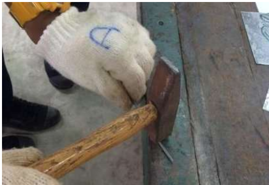
รูปที่ 3.96 แสดงการตีพับเข้าขอบตลอด
