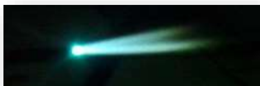
รูปที่ 2.75 แสดงการปรับเปลวออกซิไดซิงเฟรมหรือเปลวเพิ่ม
