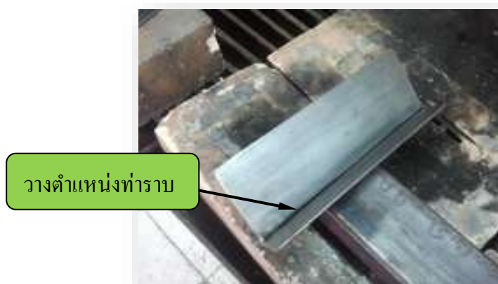
รูปที่ 2.165 แสดงลักษณะวางชิ้นงานในตำแหน่งทำราบ
