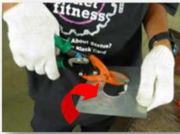
รูปที่ 3.63 แสดงการใช้กรรไกรตัดโค้งขวา
