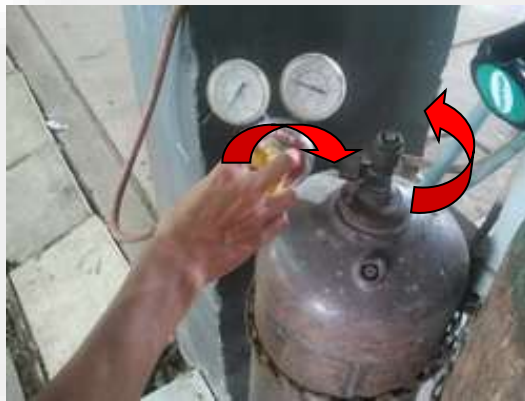
รูปที่ 2.123 ลักษณะการปรับความดันแก๊สอะเซทิลีน
