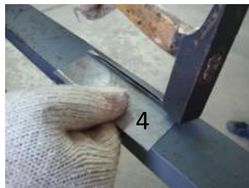
รูปที่ 3.96 แสดงการตีพับเข้าขอบตลอด
