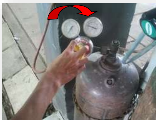
รูปที่ 2.70 แสดงการปรับความดันแก๊สอะเซทิลีน
