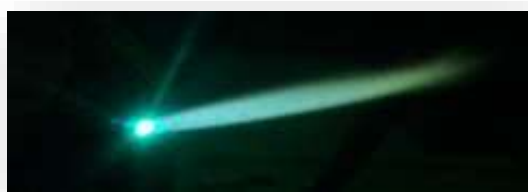
รูปที่ 2.74 แสดงการปรับนิวทรัลเฟรมหรือเปลวกลาง
