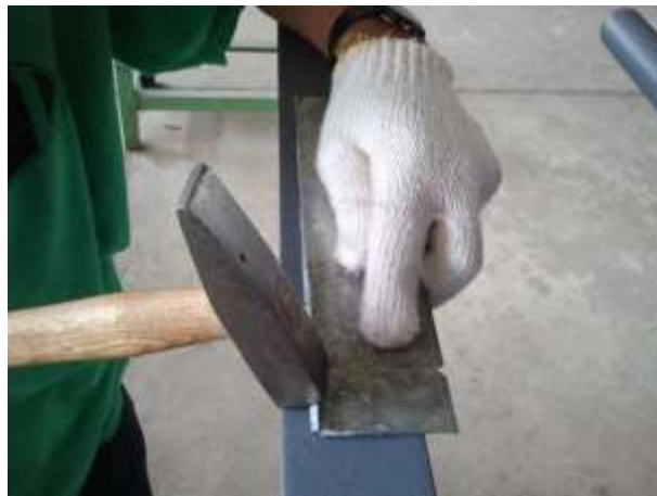
รูปที่ 3.162 แสดงการตีพับขอบสองชั้น
