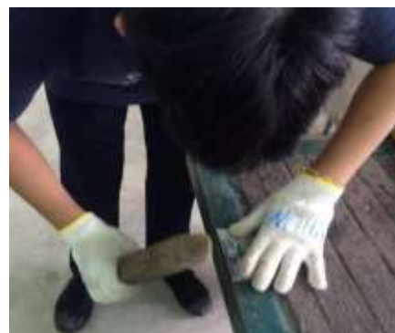
รูปที่ 3.89 การตีพับขอบ 2 ชั้น
