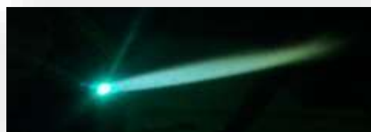
รูปที่ 2.126 ลักษณะเปลวไฟนิวทรลหรือเปลวกลาง
