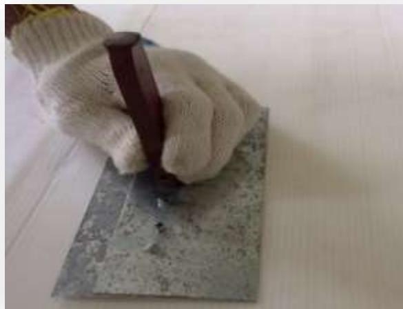
รูปที่ 3.154 แสดงการตอกชิ้นงานติดกันแนบสนิทพอดีกับหัวหมุด
