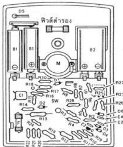
ภาพที่ 2.5 ตำแหน่งแบตเตอรี่ และฟิวส์ในมัลติมิเตอร์
