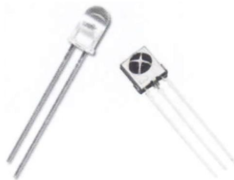
รูปที่ 15.2 อุปกรณ์ภาครับ-ส่งสัญญาณด้วยแสงอินฟราเรด
