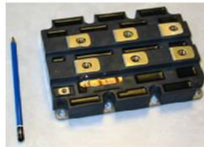
IGBT-Module 1,200 A 3,300 V
