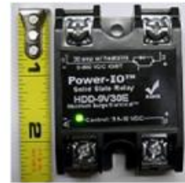
Small module 30 A, 900 V
