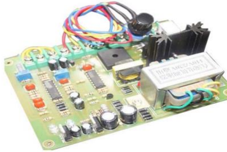
รูปที่ 6-9 วงจร SCR ควบคุมความเร็วมอเตอร์ไฟฟ้ากระแสตรงขนาด 1000W220V
