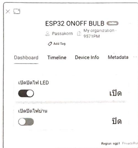
เมื่อเปิดสวิตซ์ไฟ LED แต่ปิดไฟบ้านที่ Dashboard หลอดไฟ LED จะ “ติดสว่าง” แต่ไฟบ้านจะ “ดับ”
