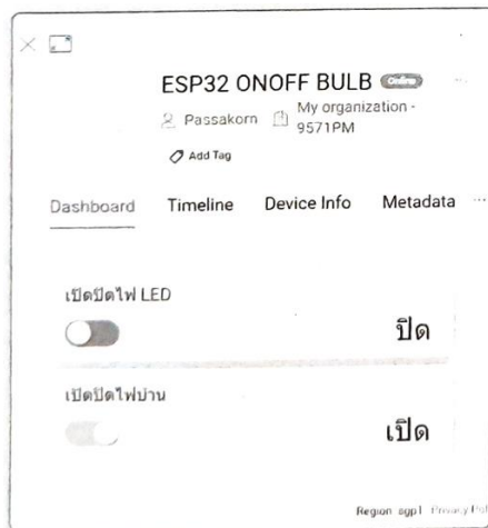
เมื่อปิดสวิตช์ไฟ LED แต่เปิดไฟบ้านที่ Dashboard หลอดไฟ LED จะ “ดับ” แต่ไฟบ้านจะ “ติดสว่าง”
