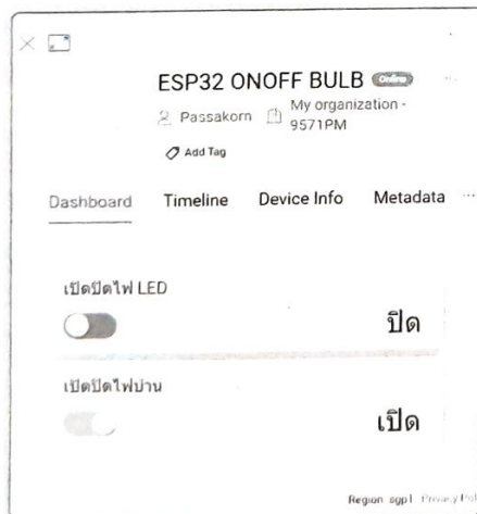
เมื่อปิดสวิตช์ไฟ LED แต่เปิดไฟบ้านที่ Dashboard หลอดไฟ LED จะ “ดับ” แต่ไฟบ้านจะ “ติดสว่าง”
