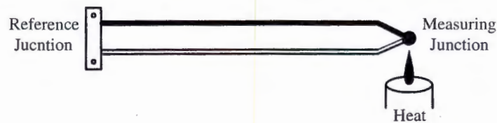
(ข) การวัดอุณหภูมิด้วยเทอร์โมคัพเบิลเปรียบเทียบกับจุดอ้างอิง
