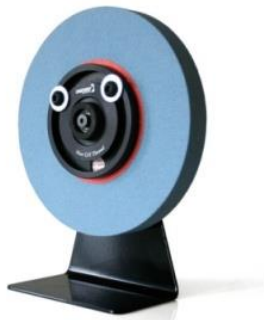
รูปที่ 2.5 การตรวจสอบล้อหินและทำสมดุลก่อนประกอบ
