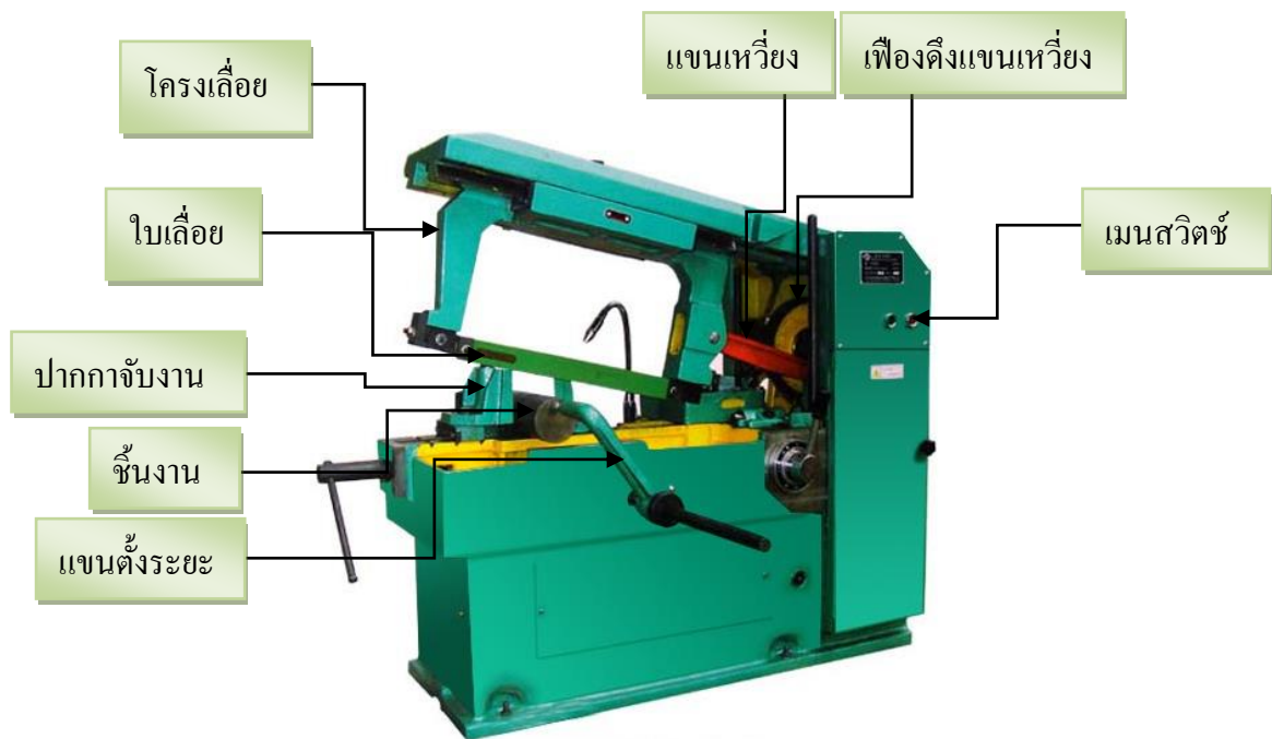
รูปที่ 3.6 เครื่องเลื่อยชักแบบข้อเหวี่ยงขนาดใหญ่
