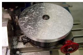
รูปที่ 6.10 การใช้หัวแบ่งแบบ Rotary Table กัดงานกลม ที่มา http://www.arab-training.com
