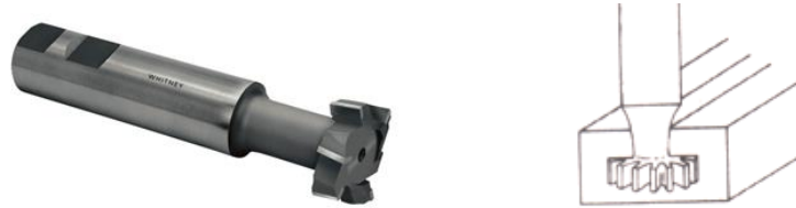
รูปที่ 6.28 T - Slot Milling Cutter และการกัดร่องตัว T
