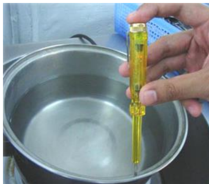
การใช้ไขควงลองไฟทดสอบไฟรั่ว
