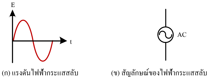
รูปที่ 3.4 แสดงไฟฟ้ากระแสสลับและสัญลักษณ์ ที่มา : ทรงศักดิ์ ครึ้นน้ำใจ, 2559
