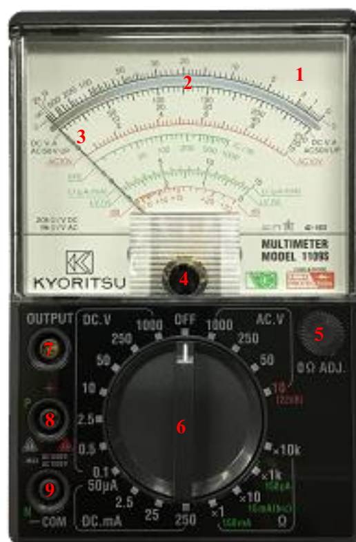
รูปที่ 2.1 แสดงส่วนประกอบของมัลติมิเตอร์แบบแอนะล็อก
