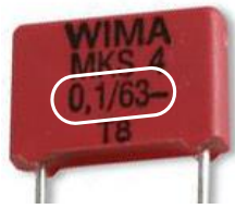
(ก) ความจุ 0.1 \mu F ทนแรงดัน 63 V
