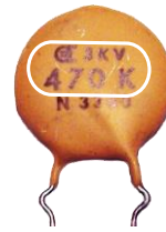
(ข) ความจุ 470 pF ค่าผิดพลาด \pm 10\% ทนแรงดัน 3 kV
