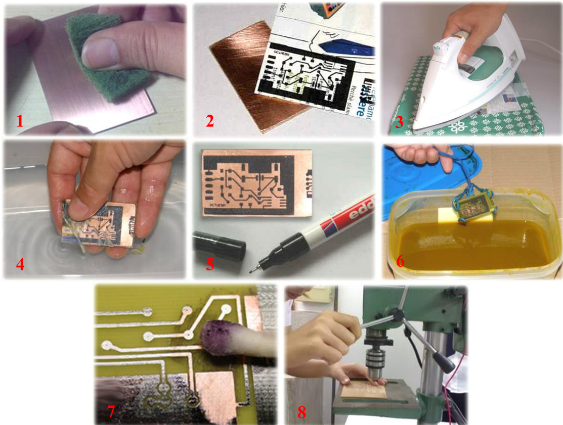
รูปที่ 17.5 แสดงขั้นตอนการสร้างแผ่นวงจรพิมพ์ ที่มา : พันธุ์ศักดิ์ พุฒิमानิตพงษ์, 2557 : 301-302
