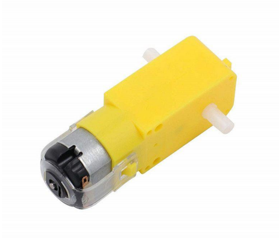
รูปที่ 3.3 มอเตอร์เกียร์แรงดันไฟฟ้ากระแสตรง 5 โวลต์ ที่มา : www.arduinoall.com
