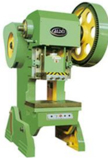
รูปที่ 1.7 เครื่องปั๊มกลไกแบบข้อเหวี่ยง (crank)
