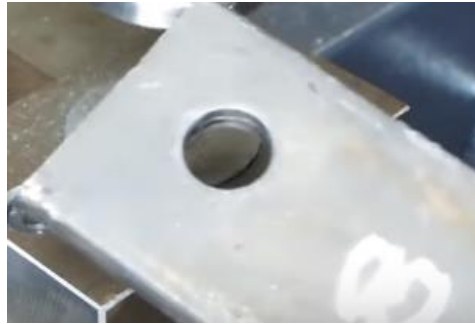
รูปที่ 1.5 ชิ้นงานจากการปั๊มด้วยแม่พิมพ์และเจาะโลหะ ที่มา : รูปภาพโดยผู้เรียบเรียง
