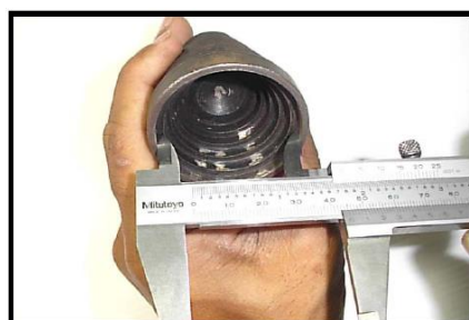
รูปที่ 4.5 แสดงวิธีการใช้เวอร์เนียคาลิเปอร์วัดขนาดภายใน ที่มา : http://www.pteonline.org/staff/index.asp?adm=komson
