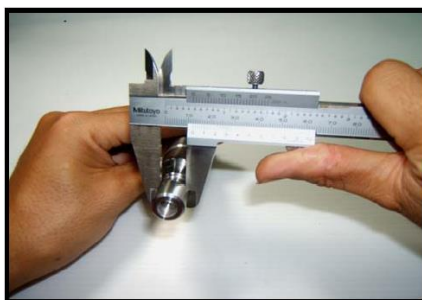
รูปที่ 4.4 แสดงวิธีการใช้เวอร์เนียคาลิเปอร์วัดขนาดภายนอก ที่มา : http://www.pteonline.org/staff/index.asp?adm=komson
