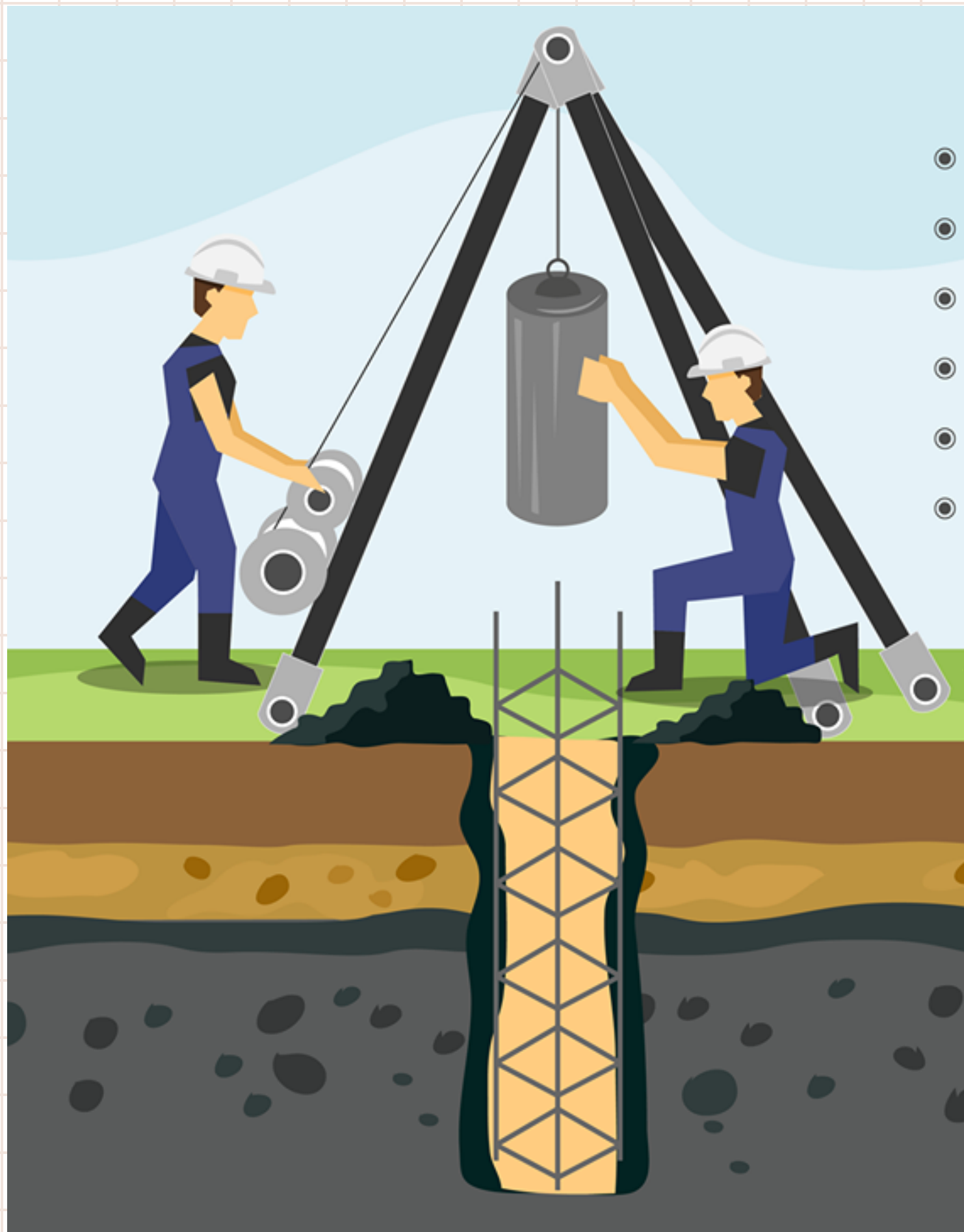
เสาเข็มแบบเจาะ
