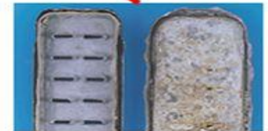
หม้อน้ำเป็นตะกอน(Radiator)
