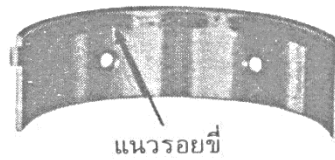
(จ) การขึ้นบนส่วนโค้งที่เจียรระโน ออกไม่หมด
