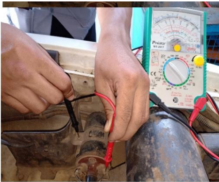
ตรวจสอบแรงเคลื่อนไฟฟ้า ที่คอยล์จุดระเบิด
