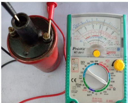
การตรวจสอบความต้านทานขดลวด ทุติยภูมิ
