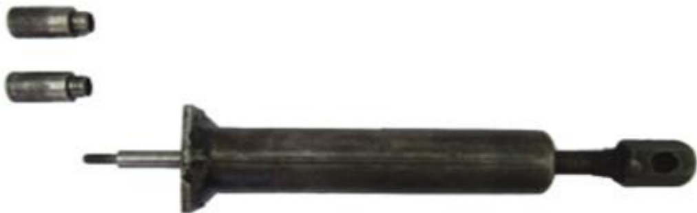
รูปที่ 1.36 แสดงเครื่องมือกดสลักลูกสูบ ที่มา : ศรศิลป์ บุญอิม. 2552.
