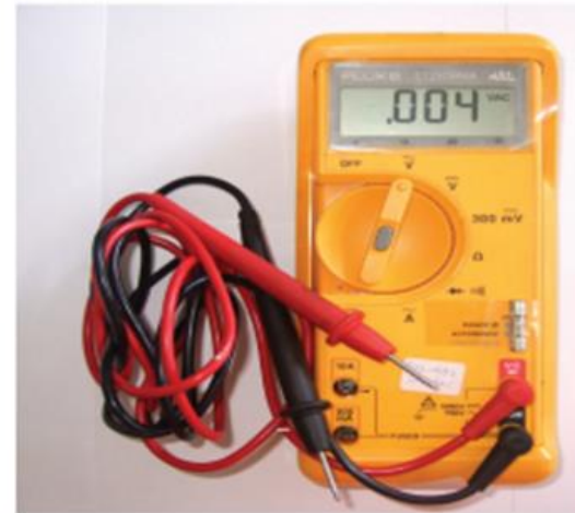
รูปที่ 1.48 แสดงมัลติมิเตอร์แบบดิจิตอล ที่มา : ศรศิลป์ บุญอิม. 2552.
