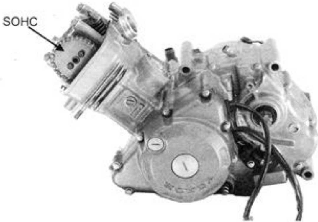
รูปเครื่องยนต์ 4 จังหวะ แบบเพลาลูกเบี้ยวอยู่บนฝาสูบ
