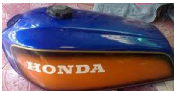
ภาพ ถังเบนซิน (Fuel Tank)
