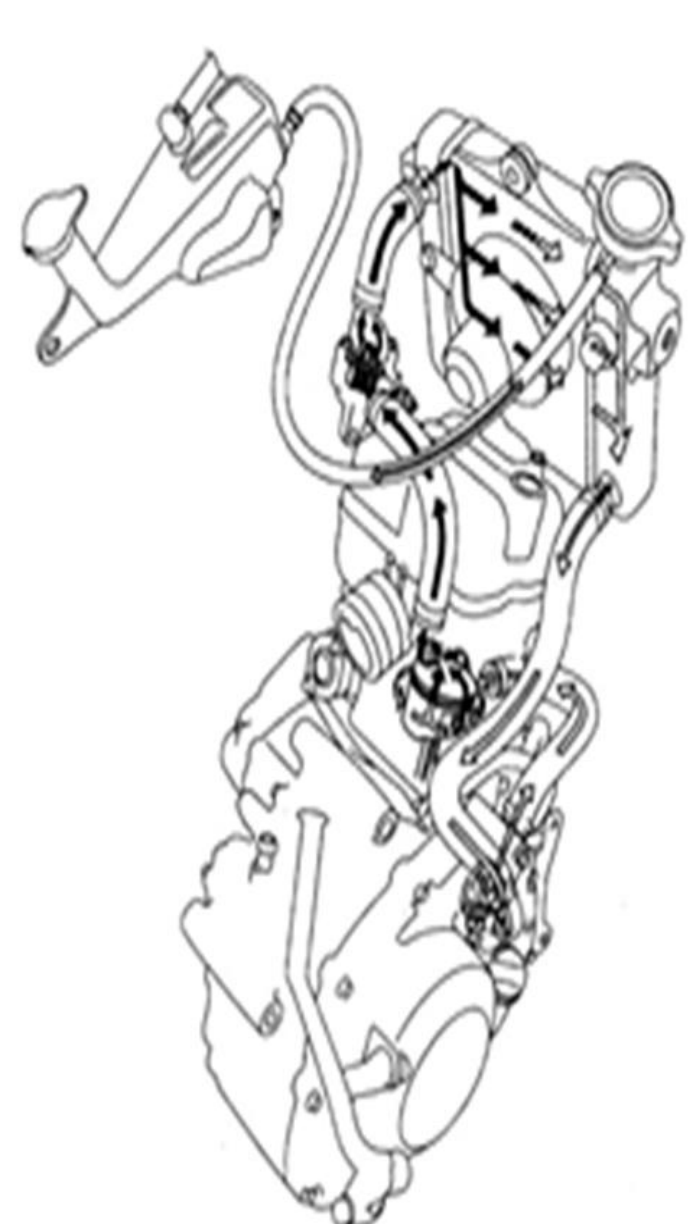
รูประบบระบายความร้อนด้วยน้ำ (รุ่น CBR)
