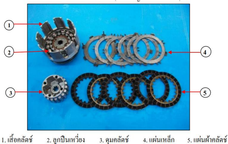
ภาพส่วนประกอบคลัตช์เหวี่ยงแบบเหวี่ยงของลูกปืน
