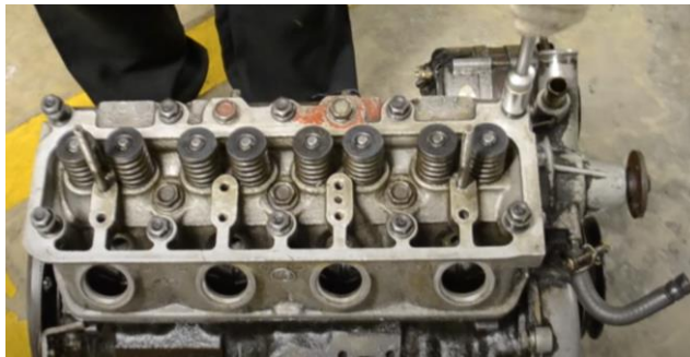
ภาพแสดง การใช้เครื่องมือคลายโบลท์ยึดฝาสูบออก
