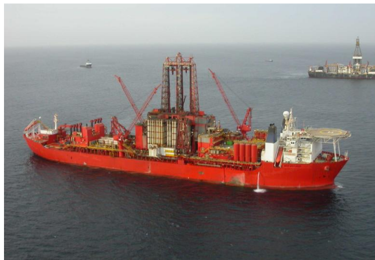
ภาพที่ 3.28 แสดงแท่นเจาะในทะเลแบบ Drillship
