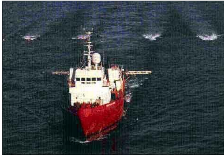
ภาพที่ 3.19 แสดงเรือสำรวจ Seismic ขณะกำลังปฏิบัติการลากสาย Geophone (ที่มา : http://www.mne.eng.psu.ac.th )
