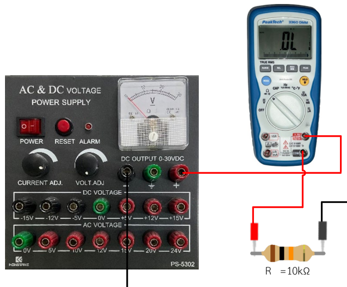
รูปที่ 3.4 วัดกระแสที่ไหลผ่านตัวต้านทานแสดงเป็นรูปเสมือน
