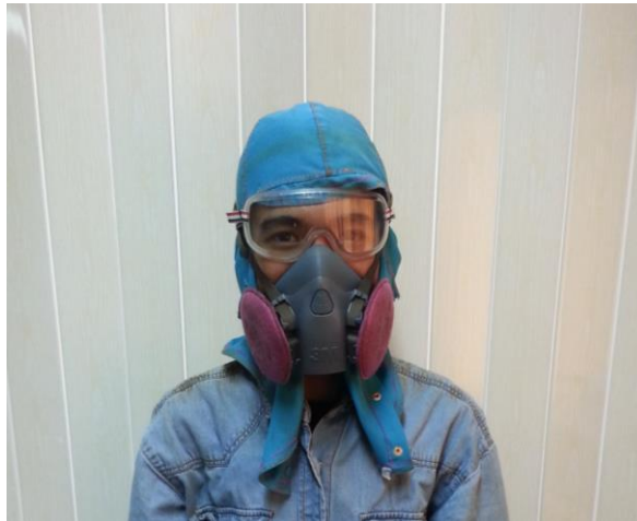
รูปที่1.1 แสดงอุปกรณ์ป้องกันดวงตาเพื่อป้องกันสะเก็ดไฟขณะทในชิ้นงานการเจียรระไนที่มาจาก พิชิตชัย จันทร์ศิริ.2560
