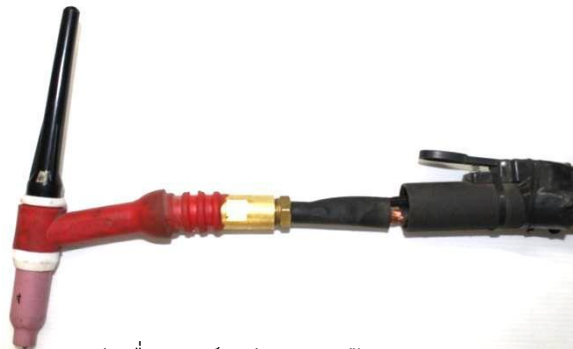
รูปที่ 2.5 แสดงหัวเชื่อมอาร์คทั้งสแตนเลสสตีล ระบบระบายความร้อนด้วยอากาศ ที่มา:ชาญชัย วิเศษสุนน.2559
