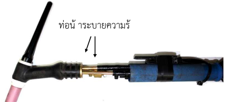
รูปที่ 2.6 แสดงหัวเชื่อมอาร์คทั้งสแตนเลสสตีล ระบบระบายความร้อนด้วยน้ำ ที่มา:ชาญชัย วิเศษสุนน.2559
