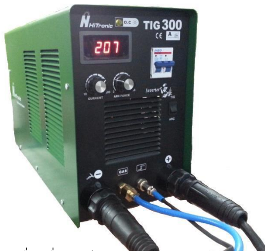
รูปที่2.1 แสดงเครื่องเชื่อมอาร์คทั้งสแตนเลสคลุมแบบ(Inverter) ที่มา:ชาญชัย วิเศษสุน.2559
