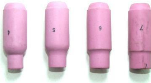
รูปที่2.9 แสดงรูปของหัวฉีดแบบกระเบื้องCeramic()
