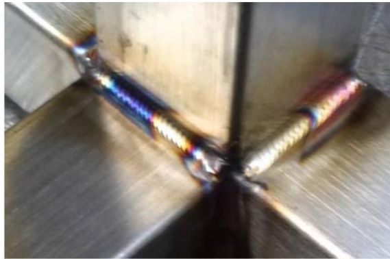
รูปที่4.5 แสดงลักษณะการส่ายหัวเชื่อมแบบซิกแซก ที่มา:เดชา เจนจบ . 2560
