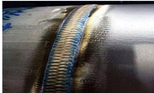
รูปที่4.6 แสดงลักษณะการส่ายหัวเชื่อมแบบวงเล็บ ที่มา:เดชา เจนจบ . 2560
