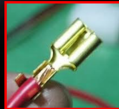
การต่อด้วยขั้วต่อแบน
