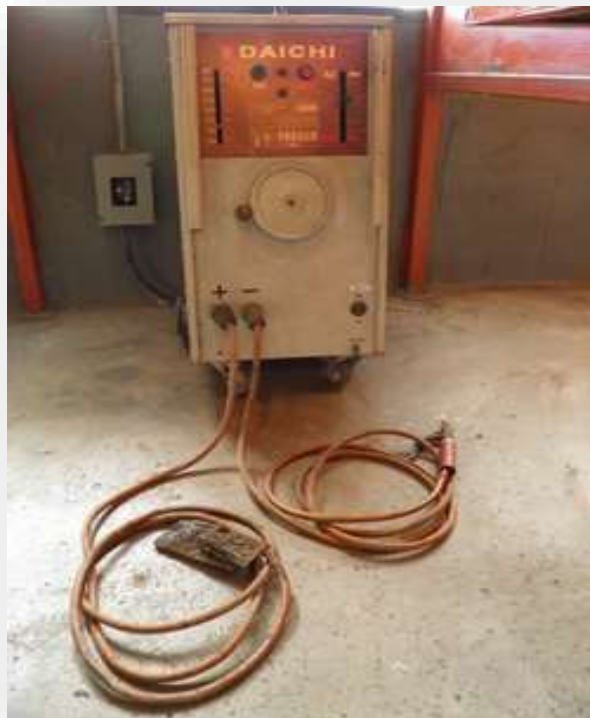
รูปที่ 1.26 แสดงการติดตั้งเครื่องเชื่อม วงจรเชื่อมแบบ DCEN
