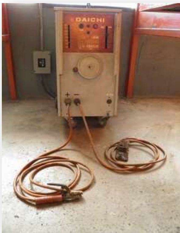
รูปที่ 1.27 แสดงการติดตั้งเครื่องเชื่อม วงจรเชื่อมแบบ DCEP
