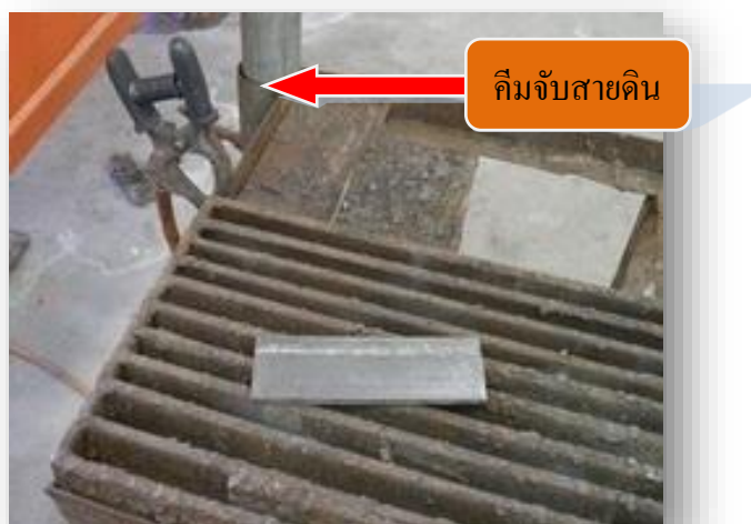
รูปที่ 1.24 แสดงการต่อสายเชื่อมกับโต๊ะวางชิ้นงาน
