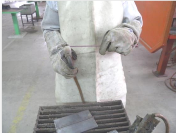
รูปที่ 1.14 แสดงการสวมถุงมือก่อนเปลี่ยนลวดเชื่อมทุกครั้ง
