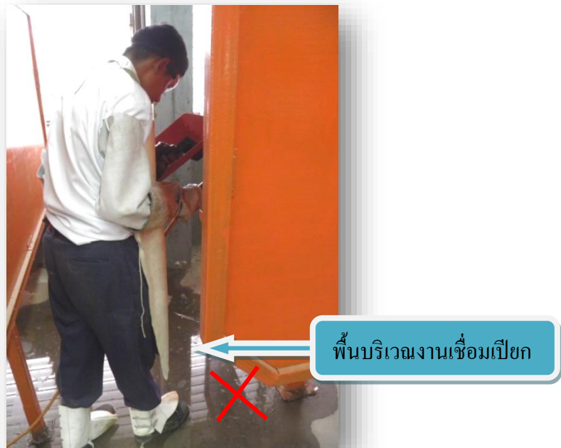
รูปที่ 1.10 แสดงไม่ควรเชื่อมงานในบริเวณพื้นที่เปียกชื้นและ
