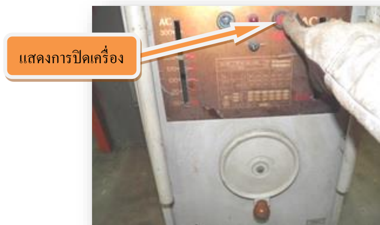
รูปที่ 1.13 แสดงการปิดเครื่องเชื่อมก่อนมีการลดหรือเพิ่มกระแสไฟฟ้า
