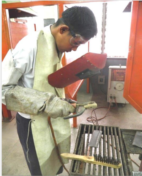
รูปที่ 1.8 แสดงการใช้หน้ากากเชื่อมก่อนทำการเชื่อมทุกครั้ง
