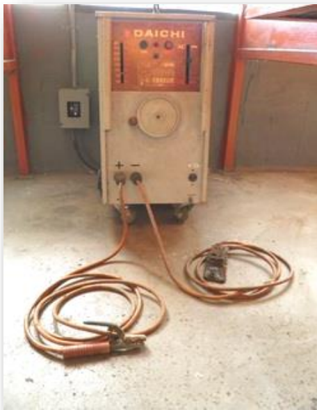
รูปที่ 1.22 แสดงการติดตั้งเครื่องเชื่อม วงจรเชื่อมแบบ DCEP
