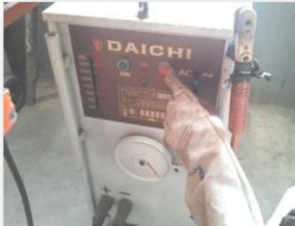
รูปที่ 1.16 แสดงการปิดเครื่องเชื่อมทุกครั้งเมื่อทำงานเสร็จ
