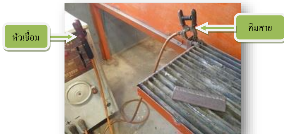
รูปที่ 1.17 แสดงการแขวนหัวจับลวดเชื่อมให้พ้นจากสายดิน
