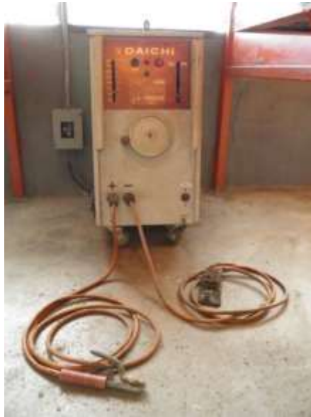
รูปที่ 1.43 แสดงลักษณะเครื่องเชื่อม DCEP
