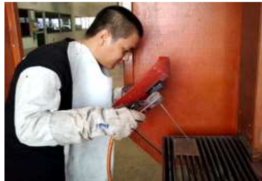
รูปที่ 1.51 แสดงลักษณะหน้ากากเชื่อมแบบมือถือและการใช้งาน
