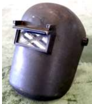
รูปที่ 1.52 แสดงลักษณะหน้ากากเชื่อมแบบสวมหัวและการใช้งาน
