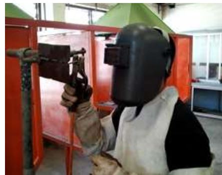
รูปที่ 1.52 แสดงลักษณะหน้ากากเชื่อมแบบสวมหัวและการใช้งาน
