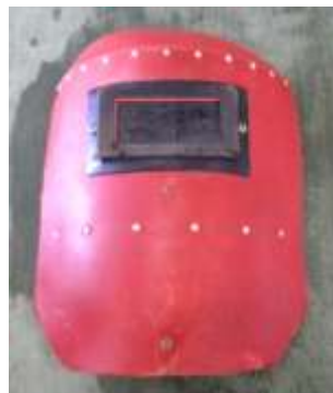
รูปที่ 1.51 แสดงลักษณะหน้ากากเชื่อมแบบมือถือและการใช้งาน
